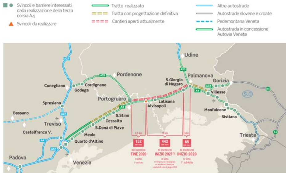
Figura 2 – Tratti interessati dall'allargamento della carreggiata con terza corsia: cantieri ad oggi in corso
